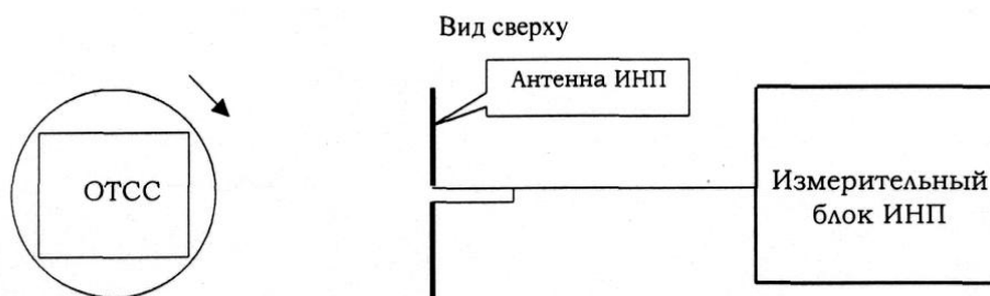
Рис. 3.18. Схема размещения измерительной аппаратуры и источника электромагнитного излучения
