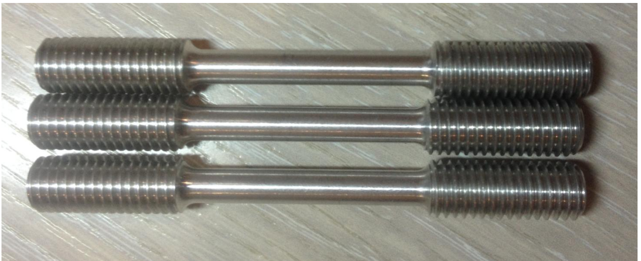
Рисунок 28 – Короткие образцы для испытаний на растяжение
