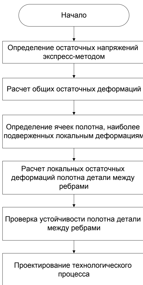
Рисунок 54 – Алгоритм расчета локальных остаточных деформаций полотна детали
