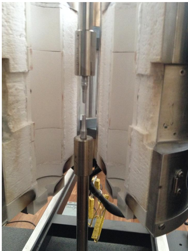
Рисунок 30 – Испытания при повышенных температурах с термобароклавом ТВВ-3
