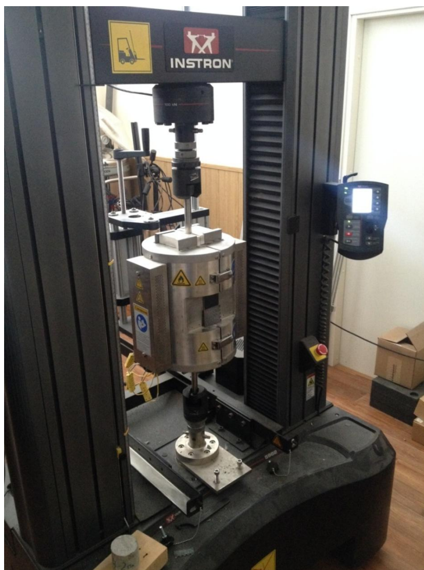
Рисунок 29 – Испытательная машина Instron 5982, с термобароклавом ТВV-3 при проведении испытаний на растяжение
