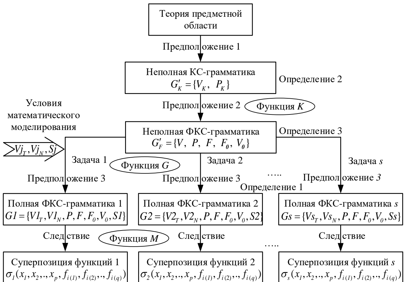
Рисунок 15 – Схема логико-математического моделирования динамических систем с использованием аппарата функциональных грамматик
