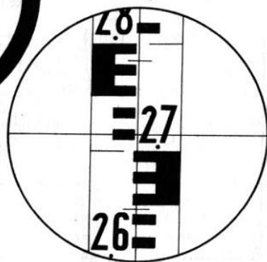
Поле зрения зрительной трубы нивелира Н-10КЛ
