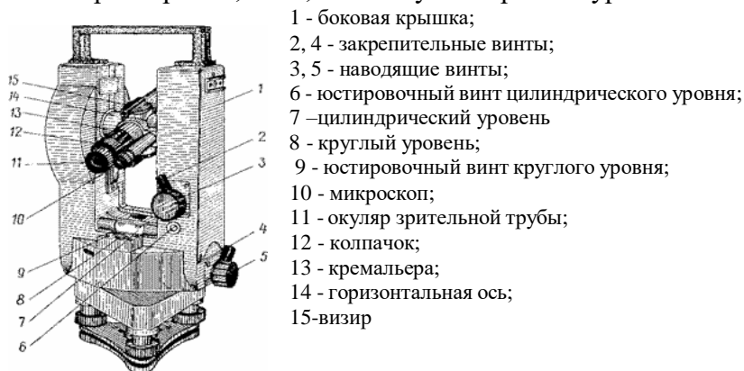
Рис 7 . Общий вид теодолита 3Т5КП
