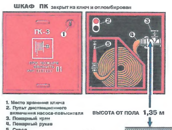
Рис. 2 - Требования к размещению внутреннего пожарного крана.
