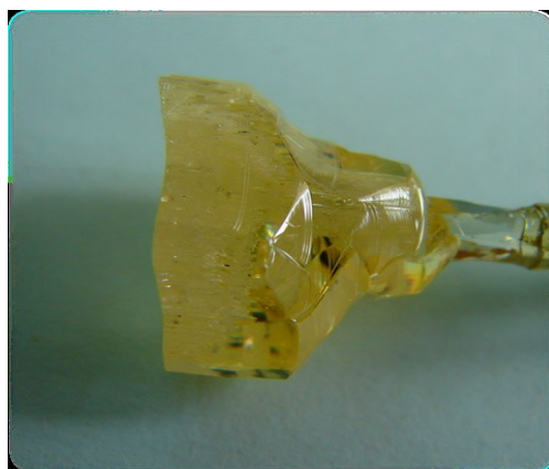
Рис. 7. Кристалл \text{Li}_8\text{Bi}_2(\text{MoO}_4)_7 , выращенный из шихты 30 мол. % \text{Li}_8\text{Bi}_2(\text{MoO}_4)_7 – 70 мол. % эвтектики системы \text{Li}_2\text{MoO}_4 – \text{Li}_2\text{Mo}_2\text{O}_7 на затравку, ориентированную по направлению [001]. Скорость вытягивания ~1 мм/сут.
