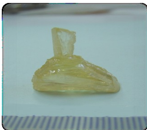
Рис. 3. Кристалл \text{Li}_8\text{Bi}_2(\text{MoO}_4)_7 , выращенный из раствора в расплаве \text{Li}_2\text{Mo}_2\text{O}_7 на неориентированную затравку
