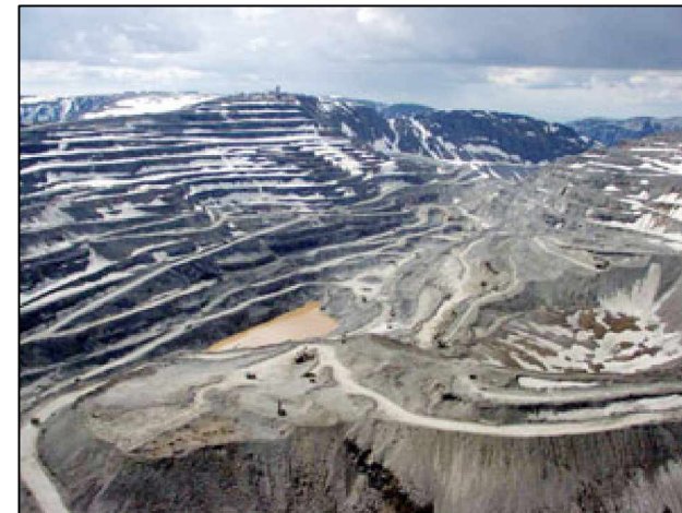
Добыча уступами при разработке наклонных и крутопадающих залежей. Высокогорный карьер.
