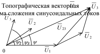
Рис. 1.7. Топографическая векторная диаграмма сложения трех синусоидальных напряжений
