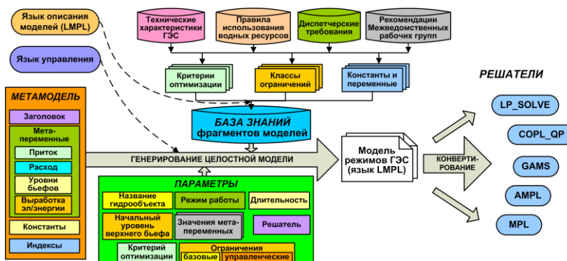
Рис. 3. Пример модельного представления процесса выбора оптимальных режимов функционирования ГЭС, полученного на основе принципа метамоделирования
