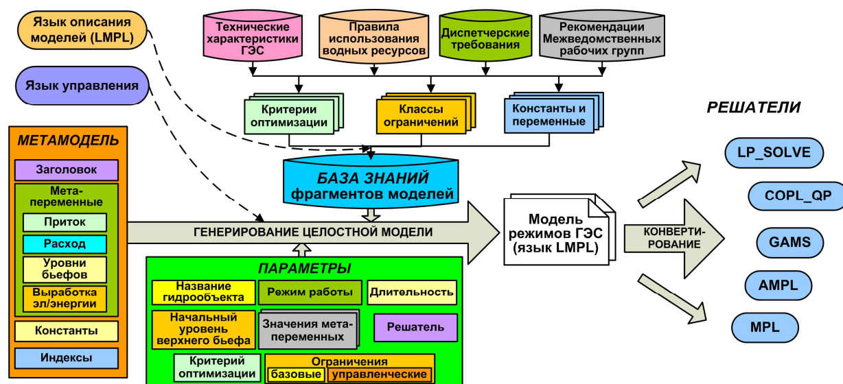
Рис. 5. Пример модельного представления процесса выбора оптимального режима функционирования ГЭС, полученного на основе принципа метамоделирования
