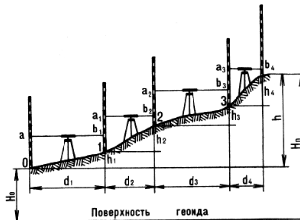
Рис. 17. Схема последовательного нивелирования.
