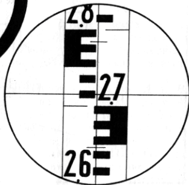
Поле зрения зрительной трубы нивелира Н-10КЛ
