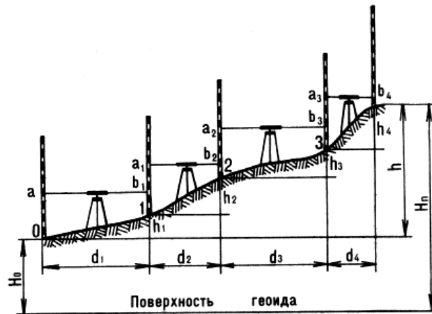
Рис. 17. Схема последовательного нивелирования.
