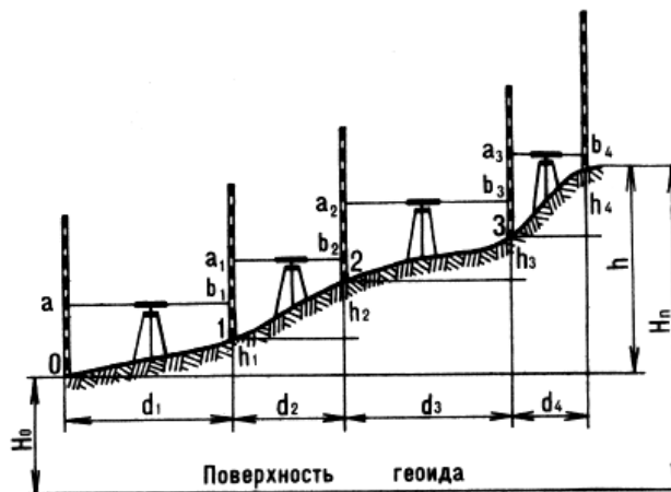
Рис. 17. Схема последовательного нивелирования.
