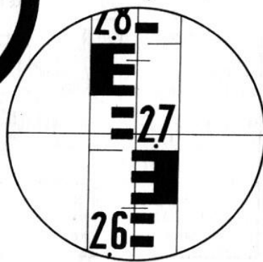
Поле зрения зрительной трубы нивелира Н-10КЛ
