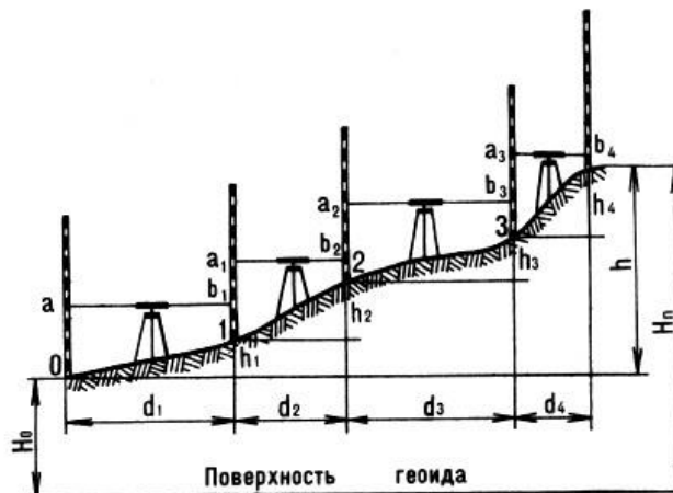
Рис. 17. Схема последовательного нивелирования.
