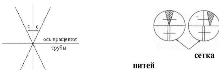
Рис. 3 Определение коллимационной погрешности: a — расчет коллимационной погрешности; б — исправление коллимационной ошибки с перемещением вертикальной нити
