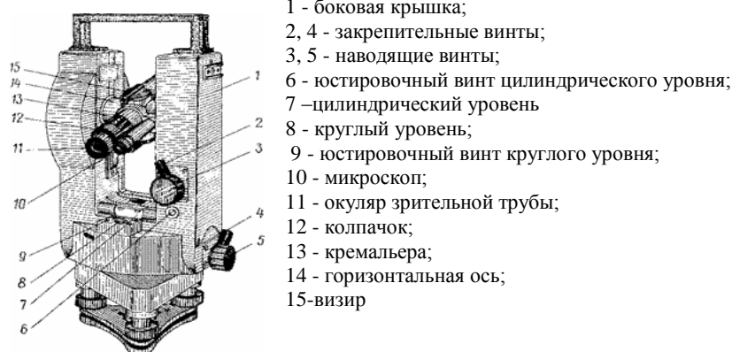
Рис 7 . Общий вид теодолита 3Т5КП
