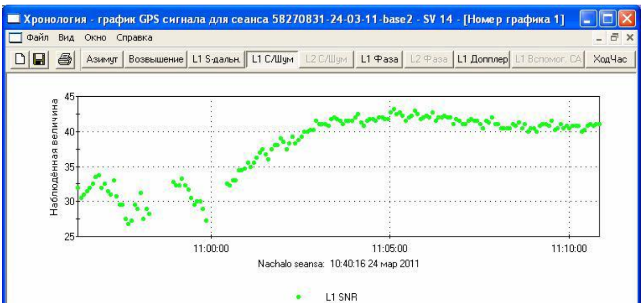
Рис. 4.9. График соотношений сигнал/шум
