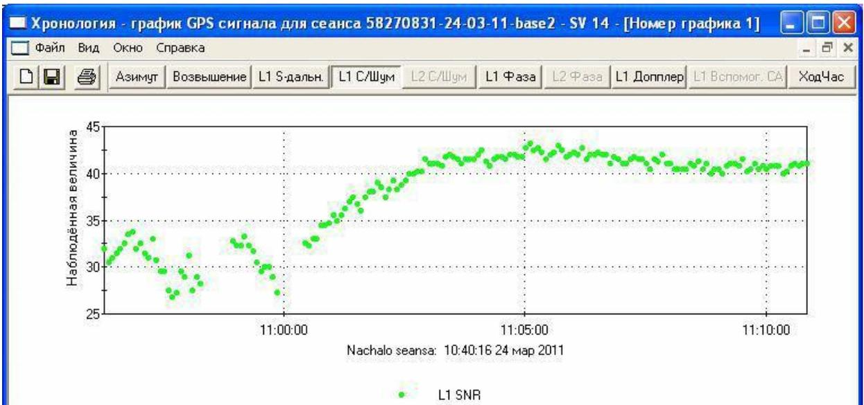
Рис. 4.9. График соотношений сигнал/шум
