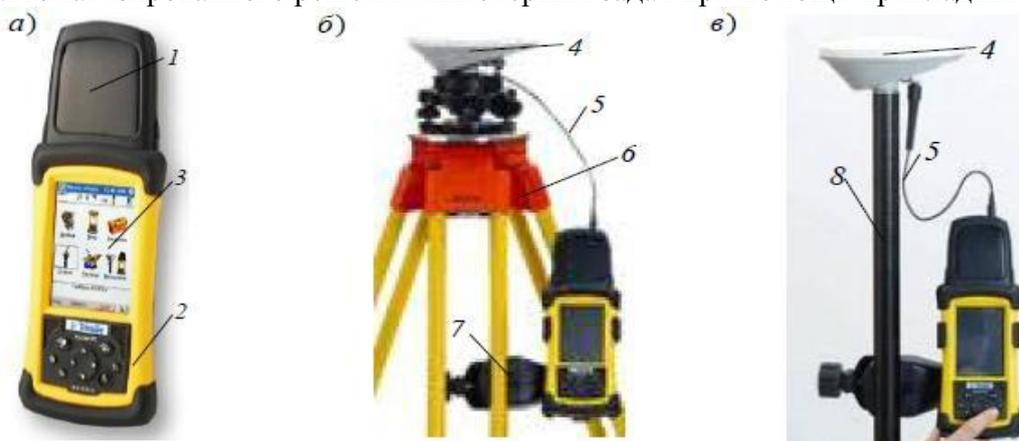
Рис. 2.1. Внешний вид и комплектность Trimble R3:
