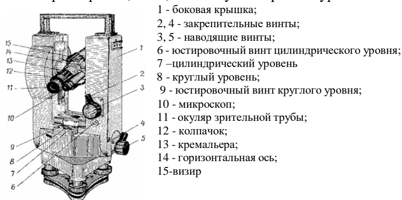
Рис 7. Общий вид теодолита 3Т5КП
